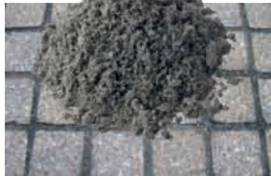
Danfugestenmel®, optimal kornfordeling, mørkt næringsfattigt granit og kvartssand samt høj pH-værdi.
